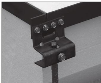
**Pince de rail** - Afin d'éviter des joints inégaux, les pinces de rail sont utilisées pour connecter tous les segments de rail, les cadres d'extrémité et les cadres de récupération. Les jambes non flottantes et les liens croisés sont placés dans des pinces de rail opposées. Les pinces de rail assurent l'alignement longitudinal, la rigidité et un réglage vertical.
