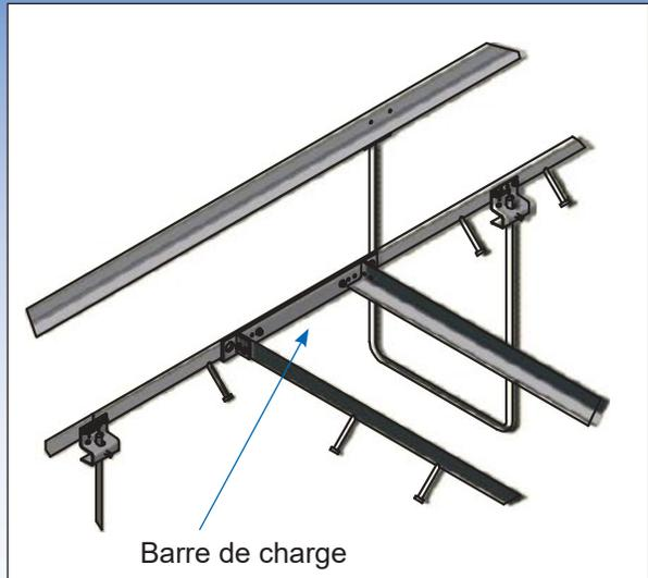
**Assemblage de rail en « T »** - Les intersections de tranchées sont faciles à monter à l'aide de rails avec barres de charge pré-montées.
