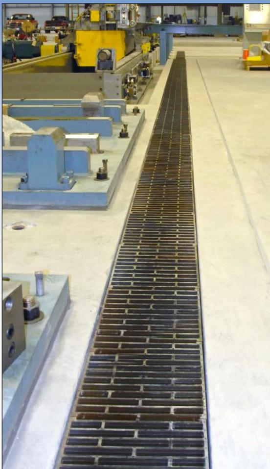
**Formes** - Fabriquées à partir de polystyrène expansé (PSE), les formes à usage unique légères et sans danger pour l'environnement créent une tranchée monolithique de haute précision. La forme peut être un rayon, carrée, trapézoïdale, ou avec d'autres formes personnalisées, selon l'option qui convient le mieux à l'application. Une gamme complète de sorties existe également.
