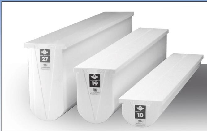
**Formes PSE** - Nos formes PSE comprennent des rainures uniques de déformation qui maintiennent les segments de mousse ensemble pendant le coulage du béton. Chaque forme peut être pré-inclinée ou neutre avec un rayon, carrée, trapézoïdale ou personnalisée. Les longueurs qui ne sont pas en pente mesurent 4' et 8' (pieds). Les identificateurs de pièce sont marqués à l'extrémité profonde (aval) de chaque section.
