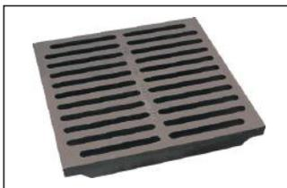
**Grille de la série 1600** - La grille du bassin de captation est en fonte et mesure 23 pouces sur 24 pouces sur 1,5 pouces et répond aux normes de charge nominale de l'AASHTO H-20.
